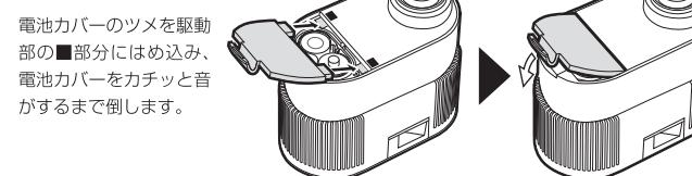
●駆動部内部への水や異物の浸入を防ぐため、電池カバーはしっかりと取り付けてください。
