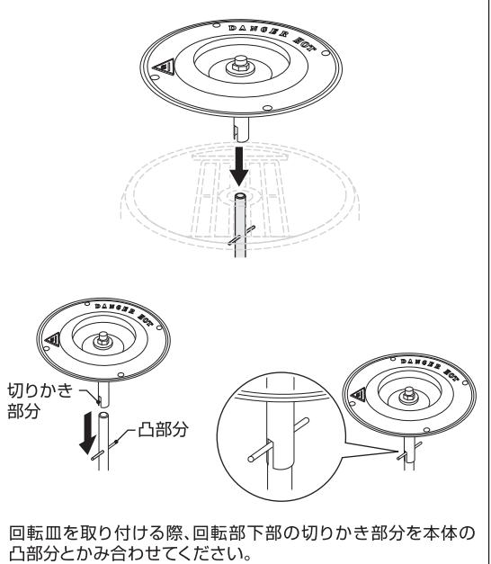
回転皿を取り付ける際、回転部下部の切りかき部分を本体の凸部分とかみ合わせてください。
