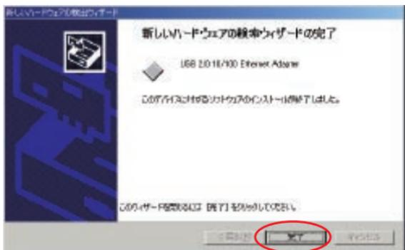
8. 確認の為、「デバイスマネージャ」を開いて「ネットワークアダプタ」に「USB 2.0 10/100 Ethernet Adapter」と表示されていることを確認して下さい。(デスクトップアイコンの「マイコンピュータ」を右クリック — 「プロパティ」で表示させます。)
