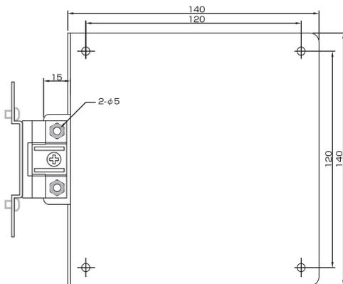
電子POP取り付け面のネジを外して、回転させ付け替えることで、電子POPの取り付け位置の高さを調整できます。
