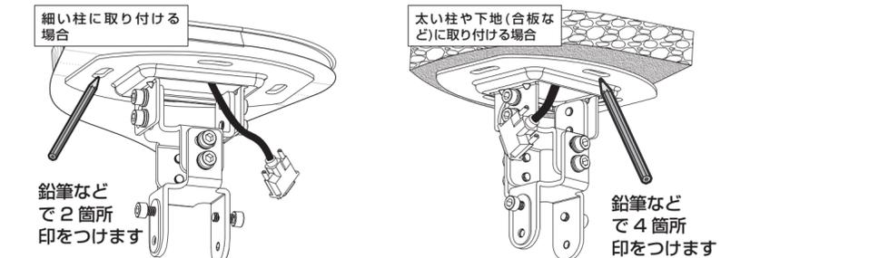
(2) 印の箇所に穴を開けます。 (3) 天井プレートを固定します。
