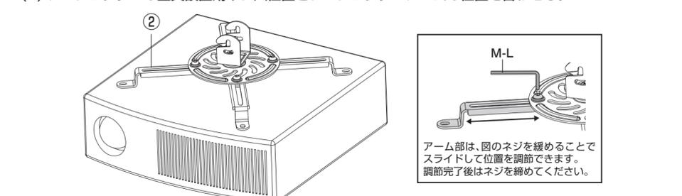
(2) プロジェクターアームをプロジェクターに固定する。 (3) プロジェクターアームを天井プレートに取り付ける。
