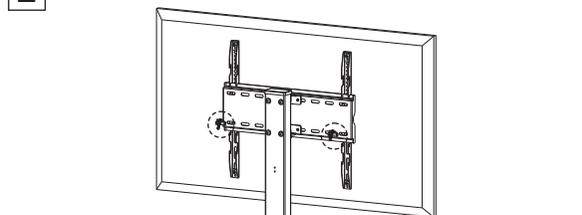
ストッパーをブラケットBの窪みに合わせ取り付け、ストッパーのネジを締め付けて固定します。
