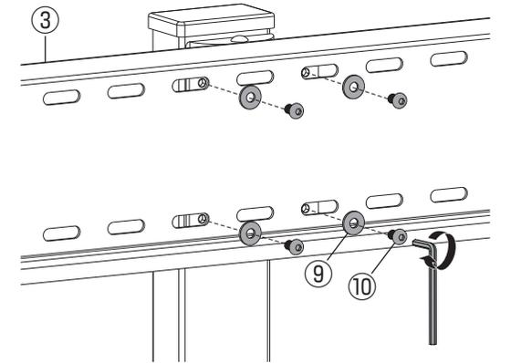
④ テレビ背面にブラケット Bを付属のテレビ取り付け用ネジ (M-A~M-G)とワッシャー(M-H)を使用して取り付けます。
