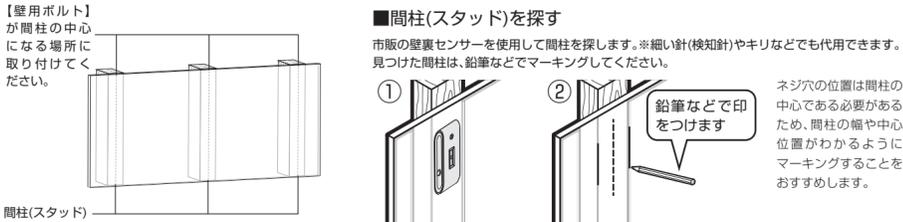
取り付け位置は、壁裏の間柱や強度が十分な壁に設定してください。石膏ボードのみへのネジ打ちでは、強度不足になります。ネジ穴の位置が間柱の中心から左右にずれると、強度が不足したり、間柱が割れてしまうおそれがあります。本製品をコンクリート壁に取り付けるための部品は付属していません。
