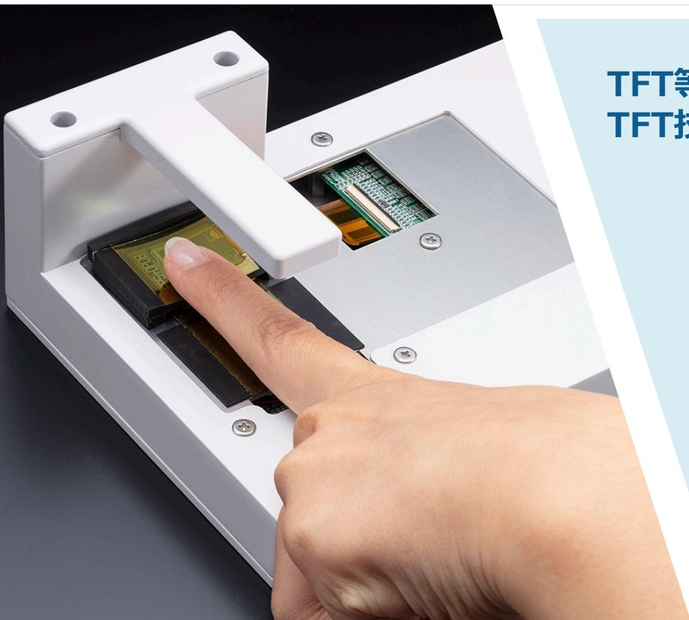
TFT等のカスタム薄膜基板の一形態として、先進的な半導体技術とTFT技術を応用し、様々なバイオセンサーデバイスにセンサー基板を実装
