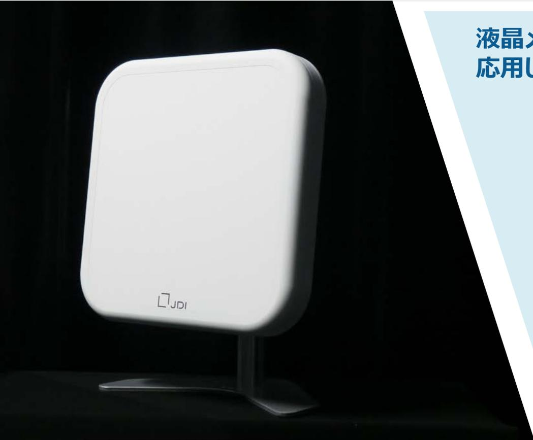
液晶メタサーフェス反射板は、当社が培ってきた液晶技術を電波の世界に応用した5G向け通信デバイス
