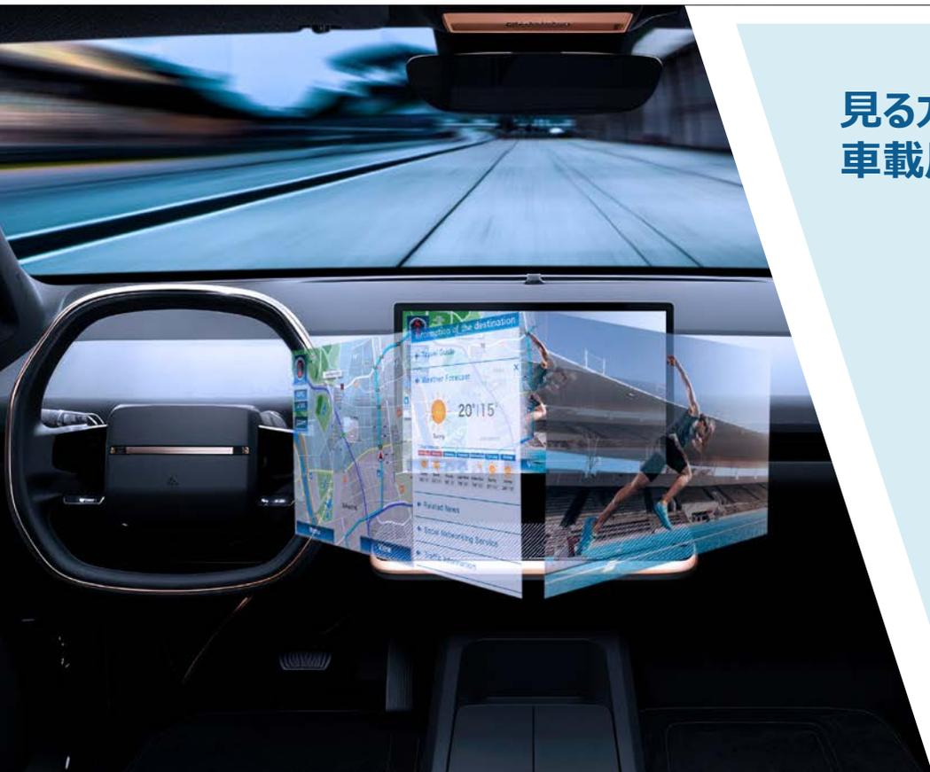
見る方向により異なる2つの映像を表示する2VDの画質を大幅に向上させ、
