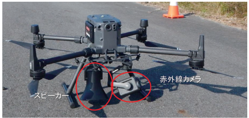
写真1. 赤外線・スピーカー搭載型ドローン
