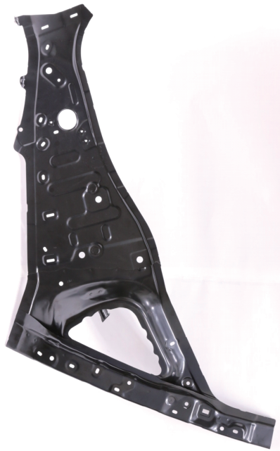
写真3 高引型 180 MPa 級冷延鋼板 (JEFORMA 1180 CR-type1) を用いた A ピラーアッパー R/F (レインフォースメント、補強材) 部品
