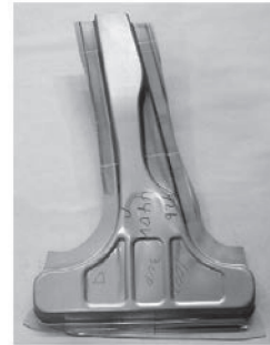
写真1 プレス部品の全体形状 (Bピラー下部モデル)
