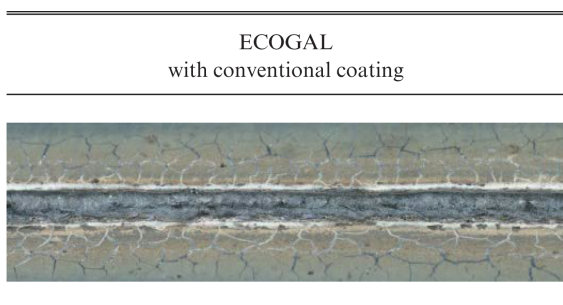
図 1 エコガル ® 化成処理鋼板の溶接後外観
