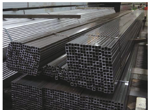
写真1 漆黒鋼板「KROJEX ® 」のインドネシアにおける角パイプへの適用例
