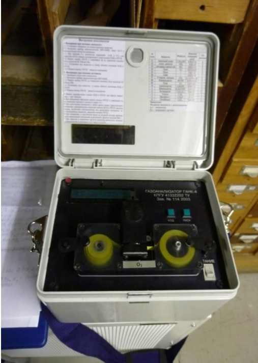
写真2 FDCC で用いられる VOC 測定器 : Universal Gas Analyzer GANK-4
