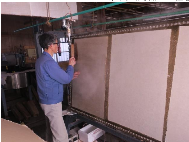
写真 6 真鍮板による熱乾燥 ：東中江和紙加工生産組合
