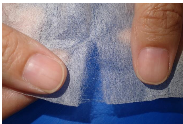
写真2) 水の線に沿って手でちぎり毛羽を出す
