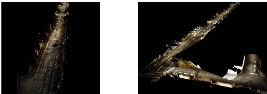
図 3 MMS による街中の 3 次元センシング
