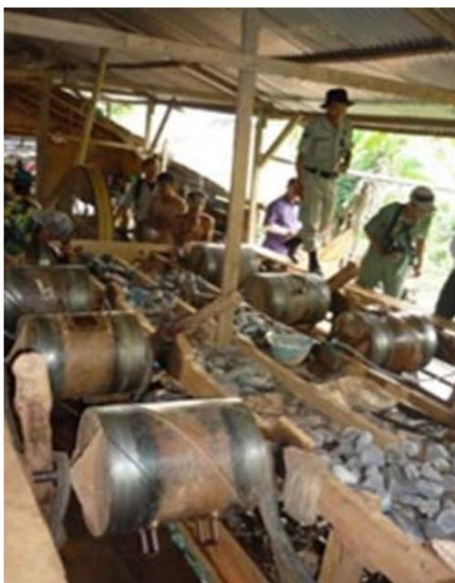
図5 小規模金採鉱の鉱石破碎ミル
