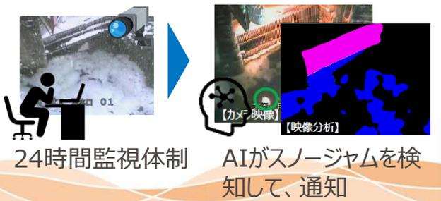
設備状態監視に向けた通信設備・センサー設置
