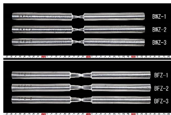
写真 5 試験後の板厚方向引張試験片 (JIS G 3199-2009, タイプ c)
