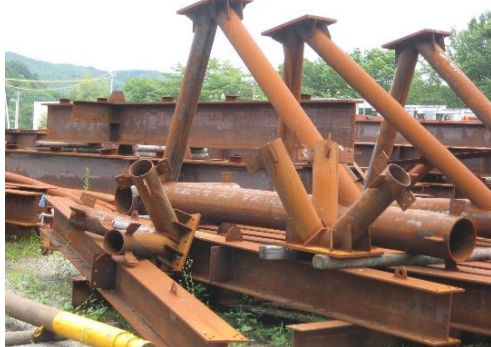
写真2 屋外保管状態
