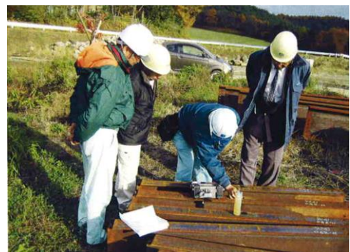
写真3 超音波厚さ測定
