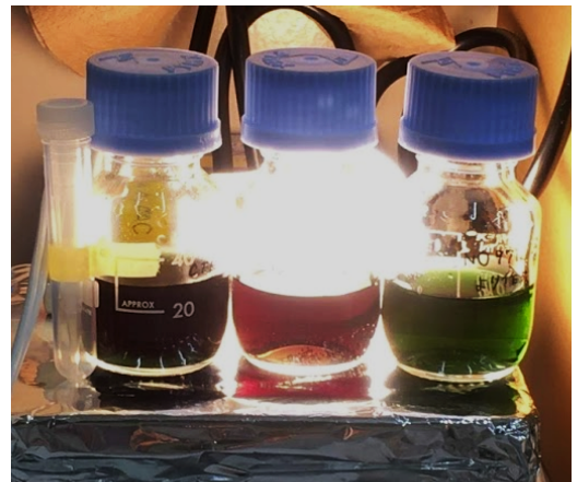
図 2 核医薬用 Ac^{3+} のモデルとしての U^{3+} (左と中央) と U^{4+}
