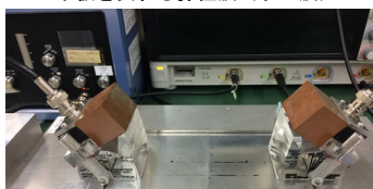
圧電探触子によるラム波計測
