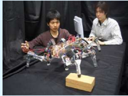
昆虫の運動知能に基づく脚型宇宙探査 ロボットの制御(上)と蝶の飛翔原理の解 明(下)
