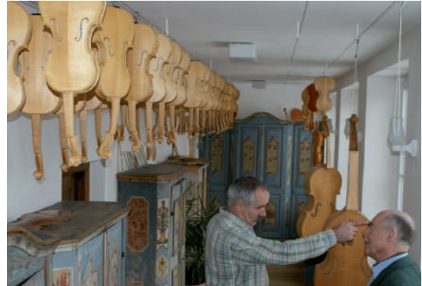
Abbildung 2: Nach einer Lackierung zum Trocknen aufgehängte Geigen (Geigenbauschule Mittenwald) (Foto: L. Gössinger)
