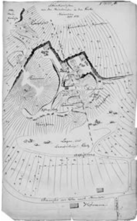
Abb. 31: Situationsplan „von den Steinbrüchen in der Porta“ (1831); die gestrichelte Linie entspricht dem zwischen dem Steinbruch Homann (Besitzer: Der königliche Forstfiskus) und dem Steinbruch des Colon Schonebohm (Betreiber: Moses Michelsohn oder Vorgänger, als Steinbruchbetreiber ab 1845 aktenkundig) bestehenden Grenzverlauf. Der Abfuhrweg wurde offenbar von beiden Steinbruchbetreibern genutzt. Ein-gezeichnet sind eine Schmiede und das Homannsche Haus für die Steinhauer.
