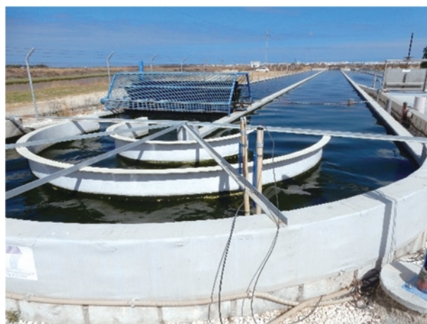
図3. 嫌気発酵消化液及びCO2排ガスを利用して培養された微細藻類(スペイン、セビーリャ; 筆者撮影)
