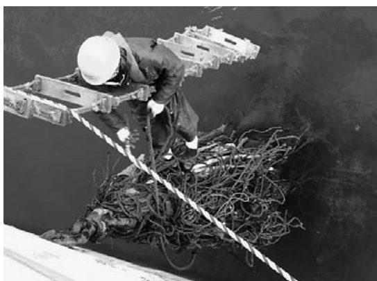
揚錨して検錨したところ、大量のロープや網が錨に絡まっているのを甲板長が除去している。
