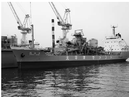
セメント専用船：硯海丸（4906 総トン） 全長：114.8m 幅：17.5m 載貨重量トン：7477 トン
