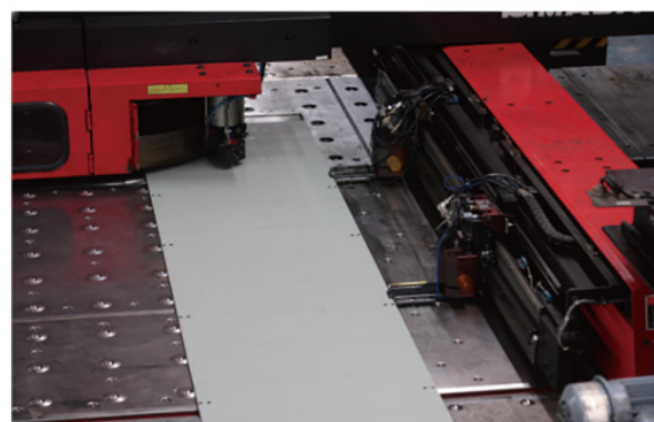
▲BIMデータによるNC加工
