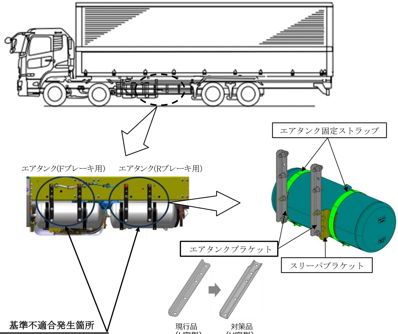
大型トラック低床4軸車のエアブレーキにおいて、共振に対する検討が不十分なため、高車速域でエアタンク周辺で共振することがある。そのため、固定ストラップに繰り返し応力がかかり、当該ストラップが疲労破断し、そのままの状態で使用を続けると、エアタンクが浮動してブラケット等と干渉しエア接続部等が損傷しエアが漏れ、ブレーキエア圧力低下の警告ランプ点灯及び警報が鳴り、最悪の場合、前輪もしくは後輪のブレーキが効かなくなるおそれがある。
