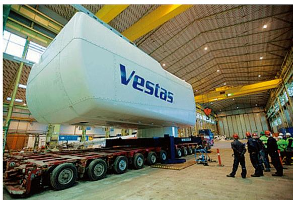
図 3-66 上試験所へ出荷を行う 8MW プロトタイプ機のナセル
