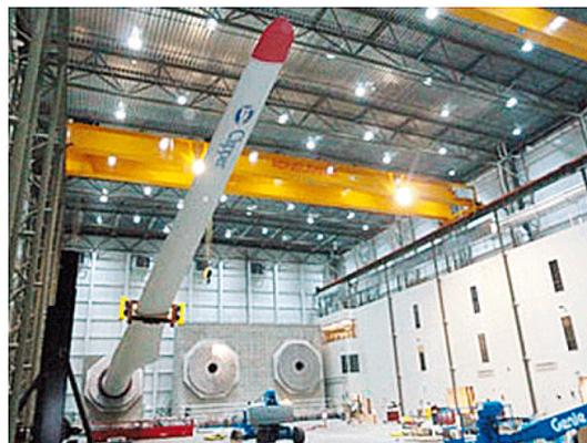
図 3-57 WTTC に設置された Clipper Windpower 社の C96 (46.7m) ブレード
