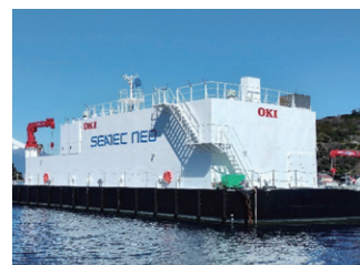
計測バージ (SEATEC NEO) 防衛・海洋計測向け
