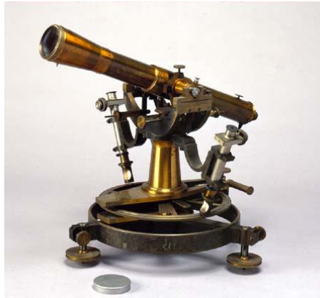
カールバンベルヒ経緯儀（左）と観測風景
