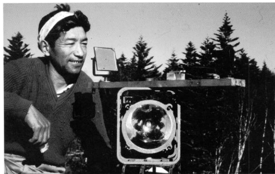
自ら発光する回光器を使用した、測量時のようす（国土地理院提供）
