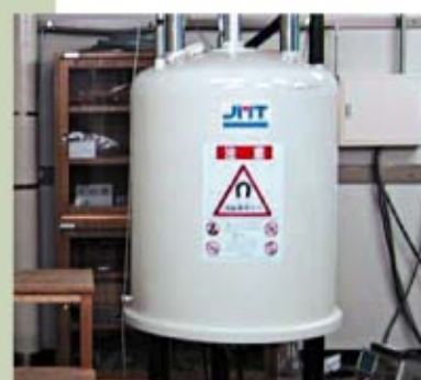
固体核磁気共鳴装置（共鳴周波数300MHz）
