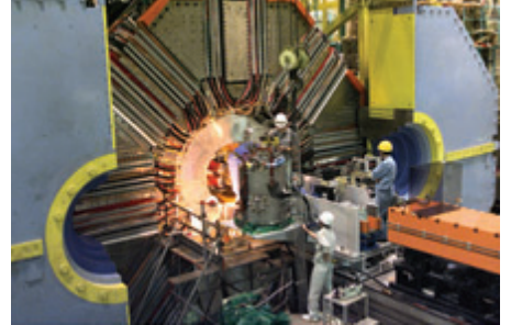
図2 電子・陽電子衝突型加速器KEKBファクトリーの Belle素粒子検出器
