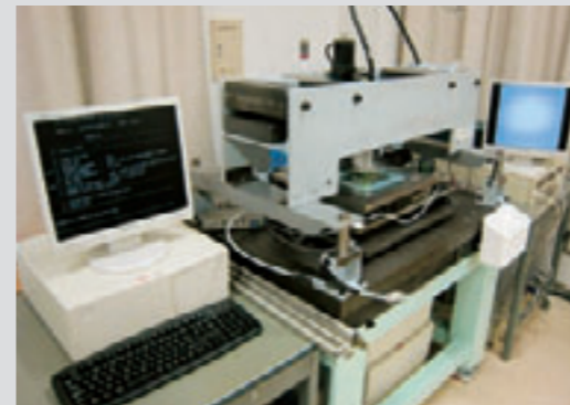
図3 超高速原子核乾板自動飛跡読み取り装置
