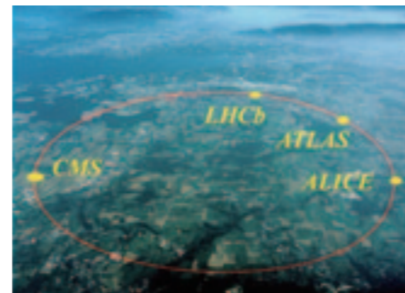
図1 CERNとLHC加速器 CERNはスイスとフランスの国境にあるLHC加速器を有する国際共同研究機関。周長27キロメートルのLHC加速器には、4つの衝突点があり、そこでさまざまな素粒子実験が行われている。名古屋大学はアトラス実験で活躍している(写真提供:CERN)。
