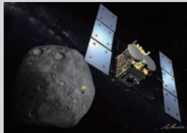
図2 小惑星にランデブーする「はやぶさ2」の想像図 小惑星に接近し、小型衝突装置(母船の左下の円筒状の物体)を切り離した状態。この装置は、母船が小惑星の陰に退避した後に爆発し、質量2kgの銅板を半球殻状に加速成形させ、小惑星表面に打ち込み、人工のクレーターを形成する予定である。これにより地下から掘り起こされた新鮮な試料の獲得を目指している。母船には青色の太陽電池パネルや2つの円形の高利得アンテナ、イオンエンジンのスラスタなどが見えている(イラスト©池下章裕)。
