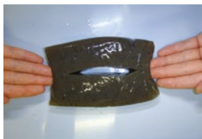
図4 割れ目の開口の実験 コンニャクの中心に十字の切れ目を入れて左右から押した場合の形状。マグマもこのような割れ目を形成しながら上昇する。
