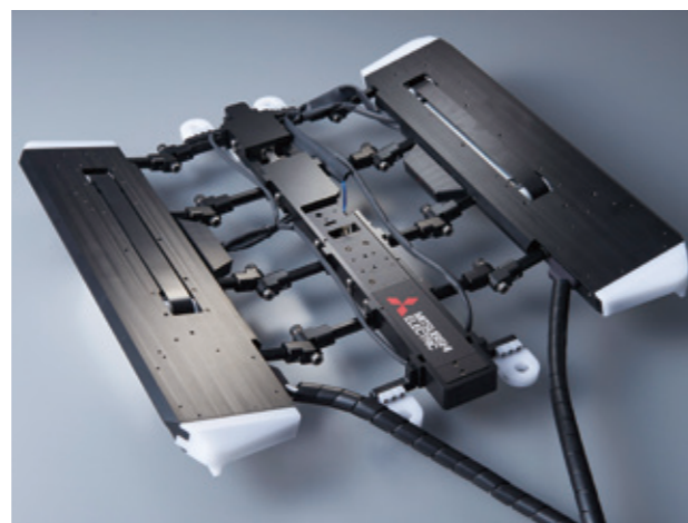
開発に携わる発電機用薄型点検ロボット
