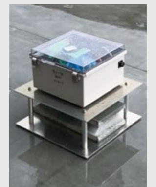
図4 地上設置の雷雲ガンマ線検出器
