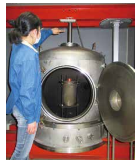
図6 衝突実験装置 火薬銃の銃身 (指さしている部分) の下端から弾丸が発射され、減圧容器内に置かれた試料 (オレンジ色の部分) に衝突する。これにより、試料は最高900℃、35GPaの高温高圧状態になる。弾丸の減速を防ぐため、装置内は減圧状態に保たれる。
