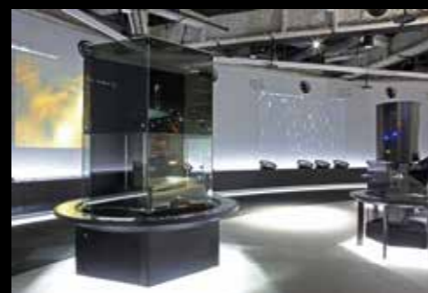
◇写真の説明 名古屋市科学館における放電箱の常設展示。1978年に名古屋市科学館は日本で初めて放電箱の一般公開を行った。現在の装置は外装を変えているが、放電箱そのものは科学館導入時のままで作動させている。写真は宇宙線粒子の飛跡に沿って放電箱で起こる放電の様子と展示外装。
