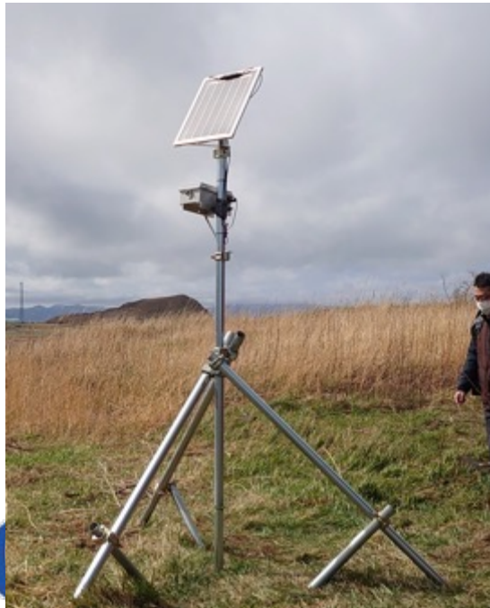
望遠カメラ×2 広角カメラ×2 コンピュータ 気圧気温湿度センサー
