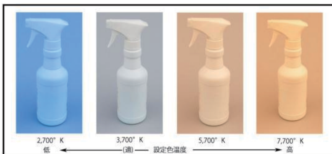
図 16 照明色温度 3,700° K のとき、図中の各色温度設定で撮影した際の画像
