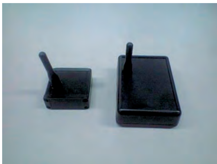
写真 5 - 9 機能試験用装置の外観 (右が移動して使用したセンサーノード、左が固定して使用したセンサーノード)
