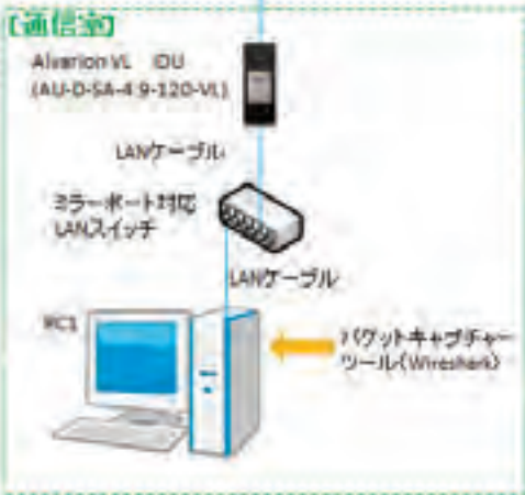
図 3-1-9 偏波面の違いを調べる構成図
