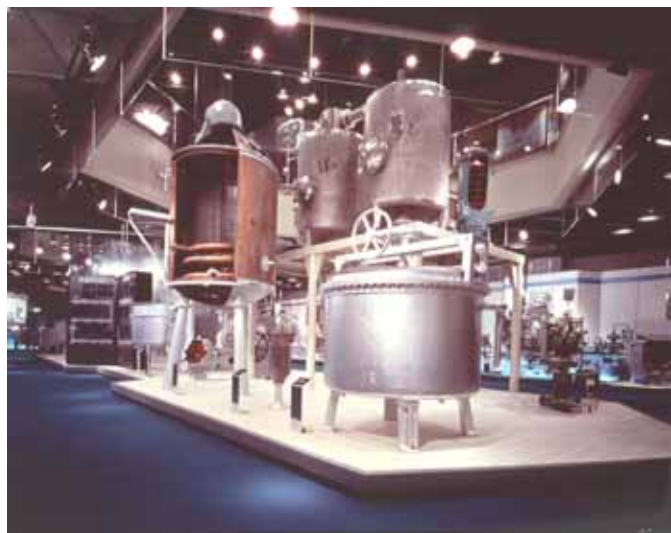
昭和10年代に使用されていた冷却機(サリター型)や濃縮機(シングル真空釜)の実機です。
