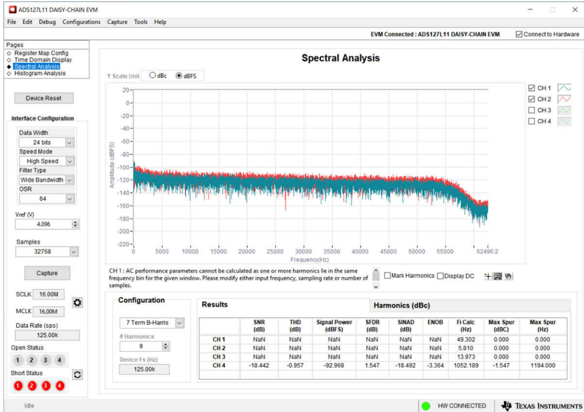
图 4-16. 通道 1 上 10V PP 时钟图像输入的频域图
