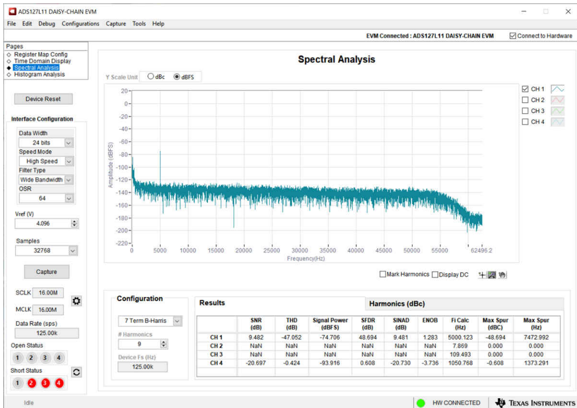
图 4-21. 应用于 IEPE 传感器的 5kHz 的频域图
