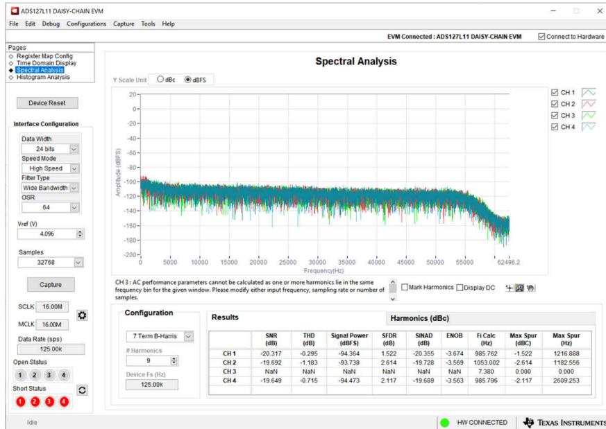
图 4-11. 前端输入短路的频域图
