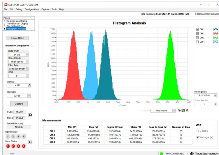
图 4-10. 前端输入短路的直方图
