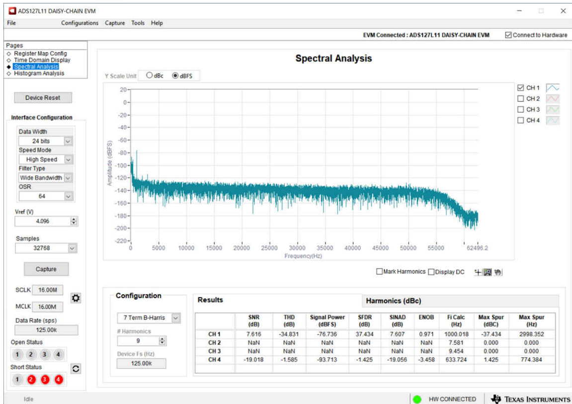
图 4-20. 应用于 IEPE 传感器的 1kHz 的频域图
