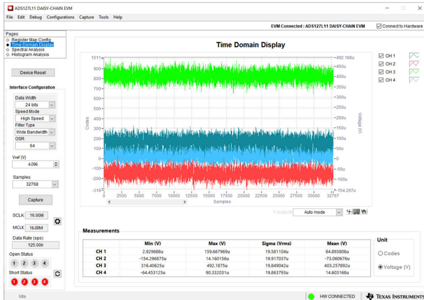
图 4-12. 前端输入短路的时域图
