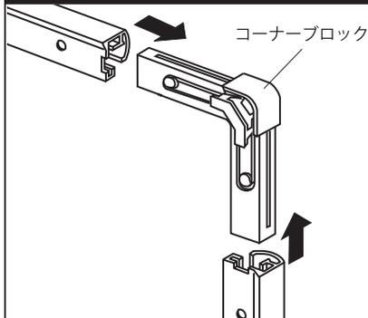
フレームにコーナーブロックを差し込み、3辺を組み立てます。(しっかりと押し込んで確実にロックして下さい)
