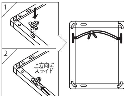
付属の吊り具をフレーム裏面の穴に図のようにはめ、上方向にスライドしてロックします。
