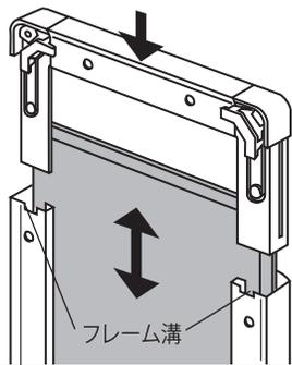
1と同様、残り一辺にコーナーブロックを取り付け四辺を組み立てます。(しっかりと押し込んで確実にロックして下さい)
