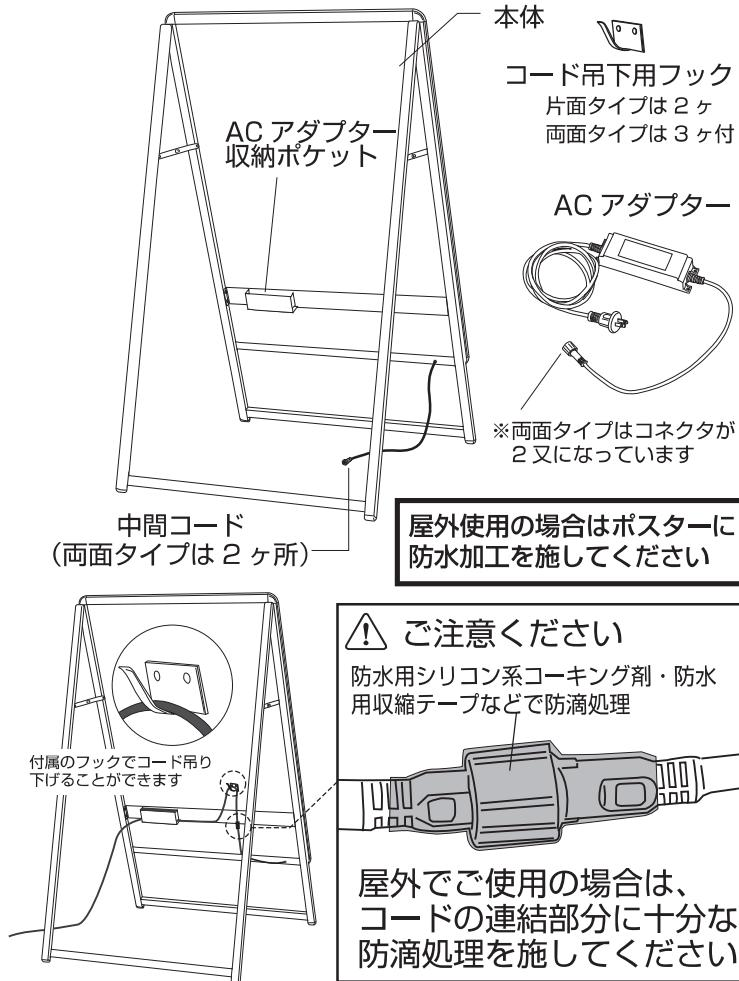
※電源は必ず適正配線されたコンセントからお取りください。(通電不良による火災または、器具不良の原因となります。)
