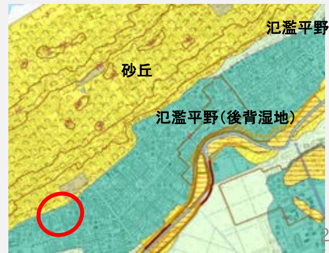
県道16号の北東側 (砂丘高地側)で舗装の圧縮ひび割れや破壊が顕著
