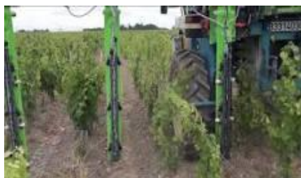
©Le dispositif SMAC proposé par la société DiiMotion coupe la pulvérisation lorsque les capteurs de la rampe ne détectent pas de feuilles. © DiiMotion
