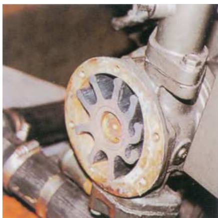
正常なインペラが取付けられている状態
