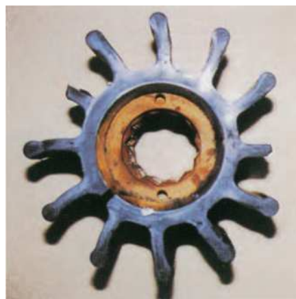
インペラの損傷例
