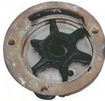
冷却水ポンプの中の摩耗と破損したインペラ
