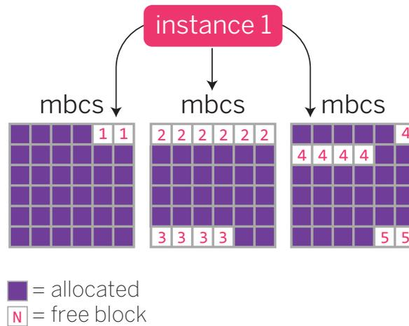
図 7.3 特定のサブプロセッサに割り当てられたメモリの例
